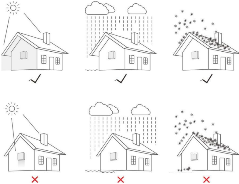
Figure 4.1 Emplacements d'installation recommandés
