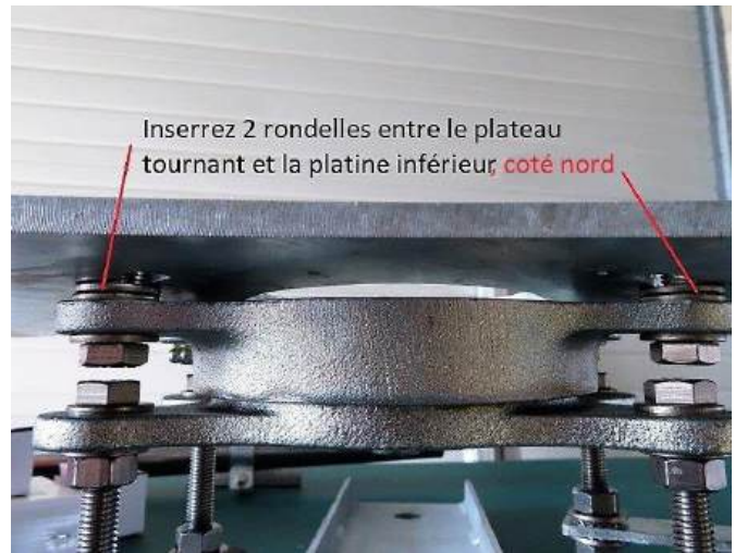
Mise en place de la platine inférieure, insérer 2 rondelles côté nord (direction du support moteur).
