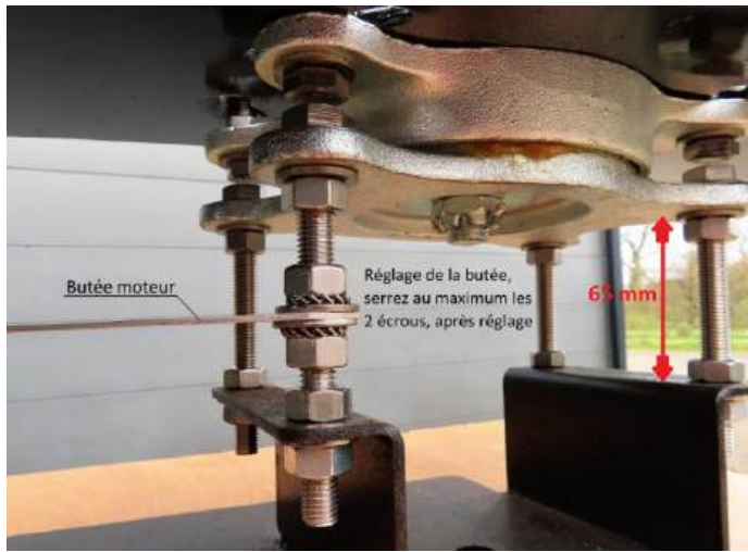
Prémontage et mise à niveau du plateau tournant. Montage de la butée moteur.
